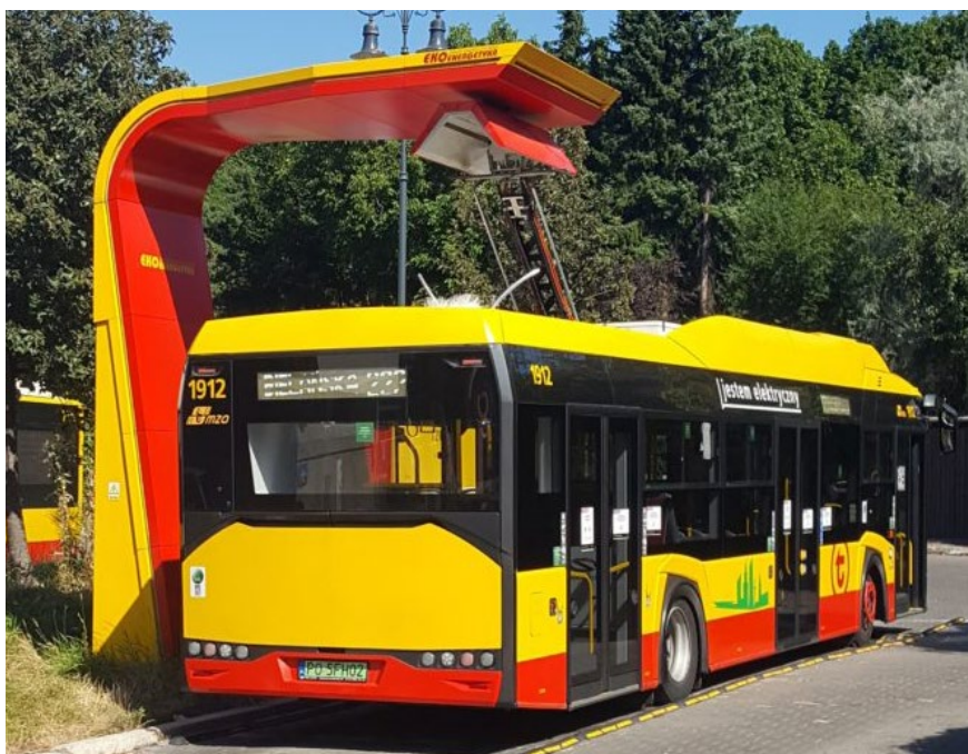
Figura 10 – Ônibus sendo recarregado via pantógrafo em Varsóvia, na Polônia
