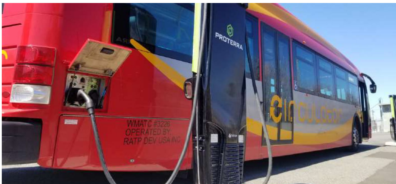
Figura 9 – Infraestrutura de recarga do tipo plug-in tradicional em Washington, D.C., nos Estados Unidos
