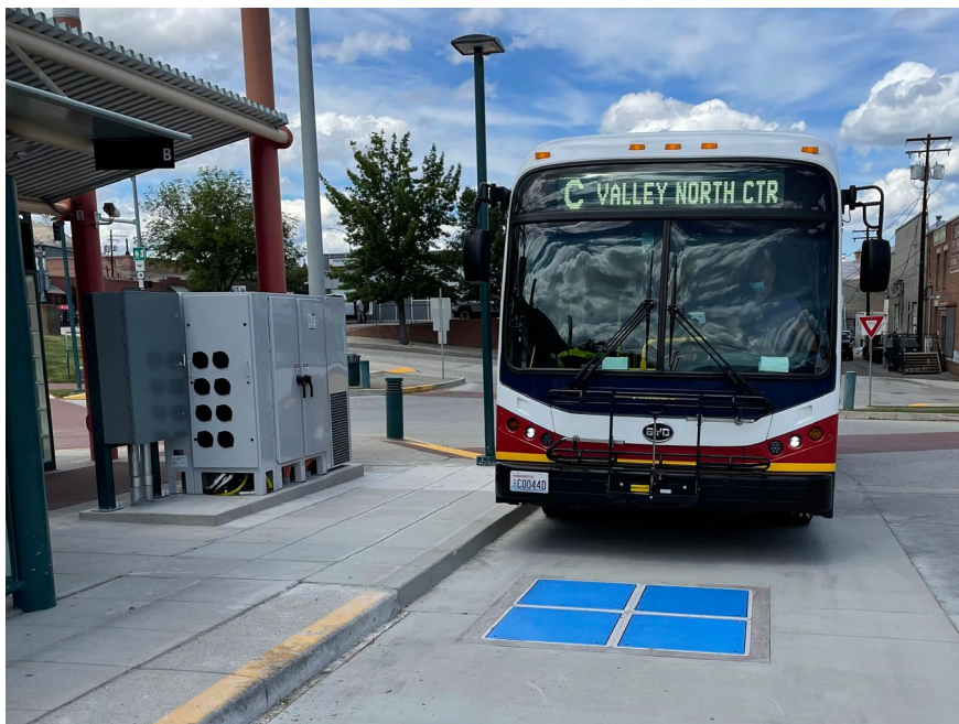
Figura 11 – Ônibus elétrico no estado de Washington se aproxima de uma infraestrutura de carregamento indutivo embutida no solo
