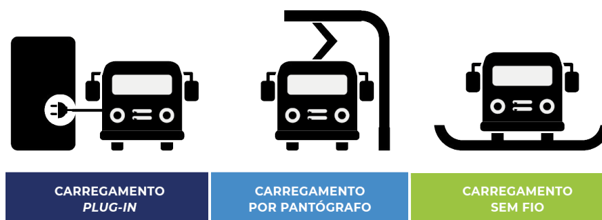
Figura 8 – Tipos de carregamento de ônibus elétricos
