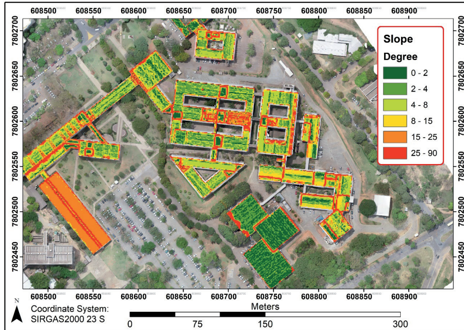
Figura 5 | Declividade dos telhados da EE-IGC-UFMG.
