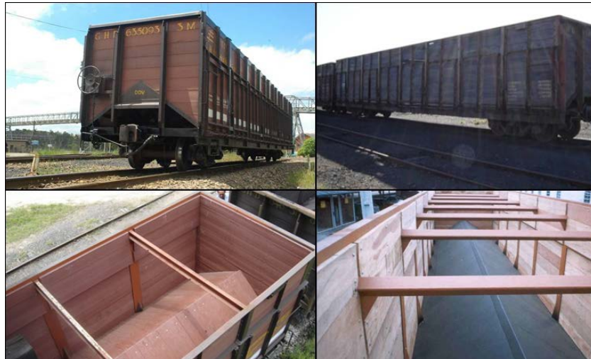
Figura 1 – Comparação: eco-vagão x vagão convencional
