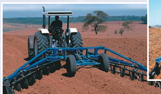
Fotos 26 e 27 – Construção mecânica de terraço tipo “mangum” – terraço de base larga, com dois canais paralelos – a montante e a jusante do camalhão central. Esse tipo de terraço é indicado para as terras agrícolas de suave declive.
