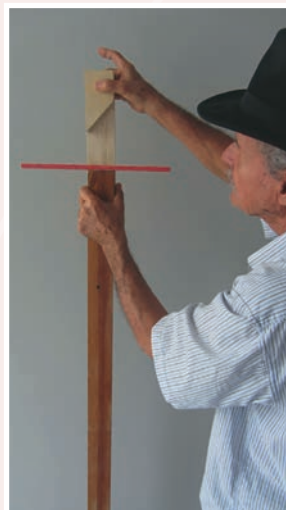
Foto 10.3 – Fixando no topo da orelha esquerda “C”, o trapézio “D”, de modo que as suas larguras se “casem” e os seus topos se nivelem
