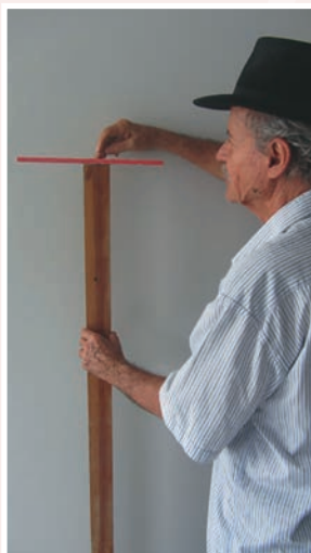
Foto 10.1 – Fixando a cruzeta “B” no topo da régua “A”, de modo que a sua largura, “case” com a espessura da régua, formando um “T” de braços iguais.
