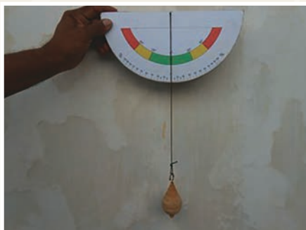
1.3 – Modelo \pi R.FA 2013 – Lado do limbo periférico em porcentagem (%) e do limbo interno em faixas de uso permitido em graus( ^{\circ} ). Mostrando também o fio saindo da aresta do diâmetro do aparelho.
