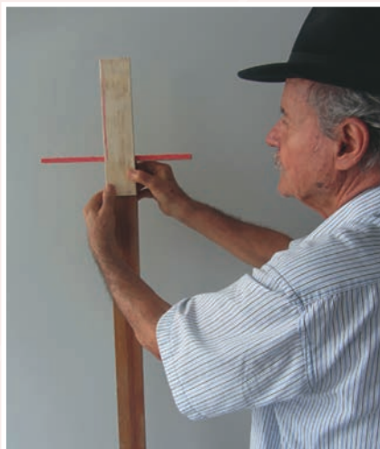
Foto 10.6 – Montagem do nivelador de alvo concluída. Bom proveito! Na fixação das peças pode-se empregar cola e preguinhos, ou melhor, parafuso defenda, com a vantagem de serem facilmente montados e/ou desmontados, tanto para o transporte como também para demonstrações práticas.
