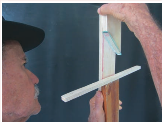
Foto 10.4 – Fixando o espelho “E” no lado inclinado (chanfrado) do trapézio “D”.
