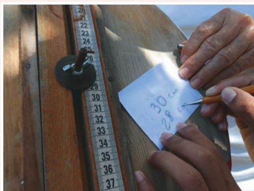
Foto 8.3 – Ajustamento da posição do alvo para locação do próximo piquete, “P1”, com pendente de 2:1000. No presente caso, o alvo sobe 2cm, para leitura 28cm, na escala atrás da mira. Vide observação na próxima página.
