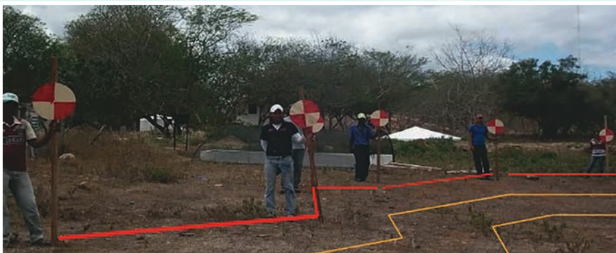
Foto 9 – Marcação de niveladas básicas (NB's) para o cultivo em contorno, pelo método das fileiras paralelas as NB's superiores. Vide fig.01 e gráfico xxi.
