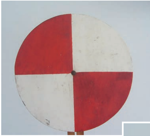
Foto 4.4 – Frente: detalhe do alvo no topo da mira.
