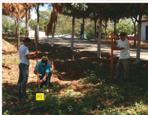
Foto 7.4 – Marcação do piquete da curva de nível, “P1”. Após o operador enquadrar o alvo, na sua visada nivelada, o auxiliar bate o piquete ao pé da mira. Nessas condições os dois piquetes têm a mesma cota. Como a curva é em nível, a distância entre piquetes pode variar. À direita, o operador com o nivelador de alvo estacionado.
