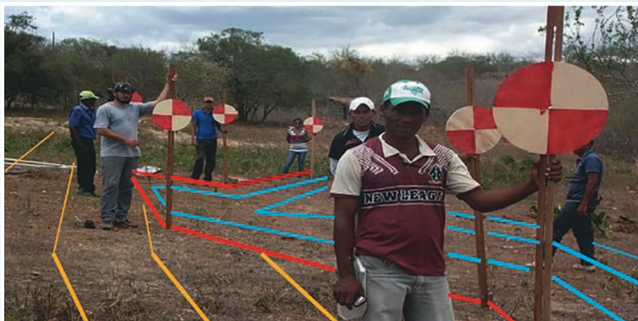
Foto 10 – marcação de niveladas básicas (NB's) para o cultivo em contorno, pelo método das fileiras paralelas as NB's superiores. Vide fig.01 e gráfico xxi.
