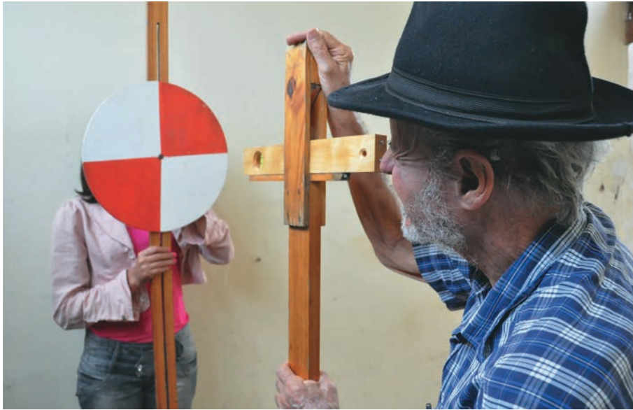
Foto 5.1 – Nivelador de alvo estacionado. Observa-se o operador tirando uma visada nivelada para a mira de alvo, pela face superior do “nível de pedreiro”, confirmada pela centralização da bolha deste, refletida no espelho, inclinado 45°.
