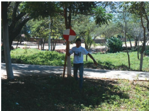
Foto 7.2 – Porta-mira deslocando-se, ao longo do contorno do terreno, cerca de dez passos, para marcação do próximo piquete da curva de nível, “P1”.
