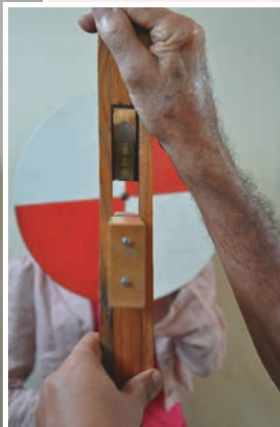
Foto 5.2 – Detalhe da centralização da bolha do “nível de pedreiro”, refletida no espelho (ver Foto 5.1)
