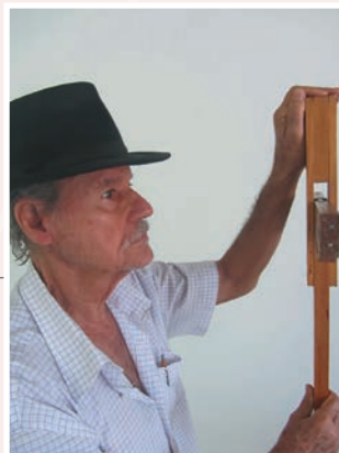
Foto 3.3 – Atrás: observe a abertura para permitir a visada
