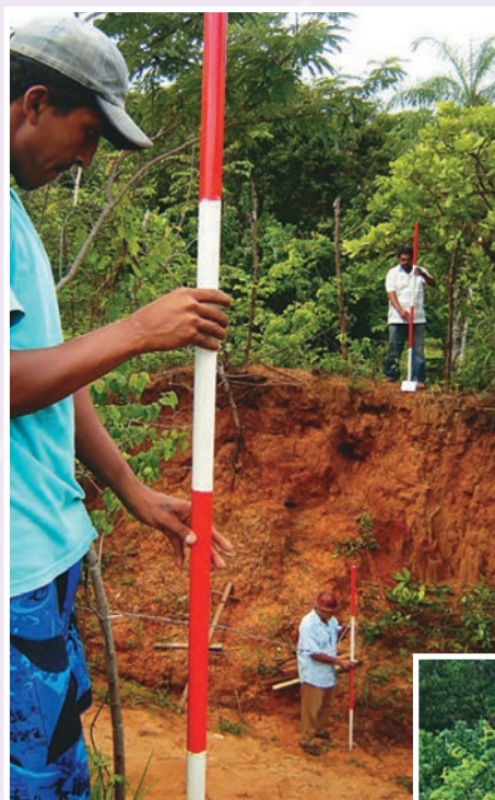
Foto 10 – Marcação do ponto mais baixo da secção do boqueirão, piquete 0 (cota zero), por visada em duas balizas nos piquetes A e A', nas margens do riacho.
