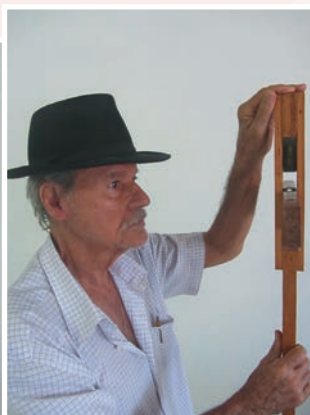
Foto 3.2 – Frente: observe a bolha refletida no espelho
