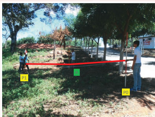
Foto 8.4 – Marcação do próximo piquete da curva com pendente, “P1”. Porta-mira tendo como raio uma trena de 10 m, cujo centro é o balizeiro no piquete inicial, “P0”, sobe ou desce a encosta ao comando do operador até enquadrar o alvo na sua visada nivelada. Em “A”, operador com o nivelador estacionado. Nessa situação a soleira da mira tem uma cota de 2cm menor do que a cota do piquete inicial, “P0”, ou seja, uma queda de 2cm, correspondente à pendente de 2:1000: 10\text{m} = 1000\text{cm} 2\text{cm} : 1000\text{cm} = 0,002 ou 2:1000.
