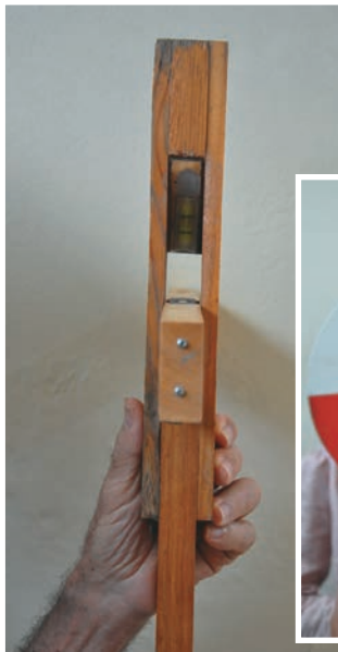
Foto 5.1 – Nivelador de alvo estacionado. Observa-se o operador tirando uma visada nivelada para a mira de alvo, pela face superior do “nível de pedreiro”, confirmada pela centralização da bolha deste, refletida no espelho, inclinado 45°.
