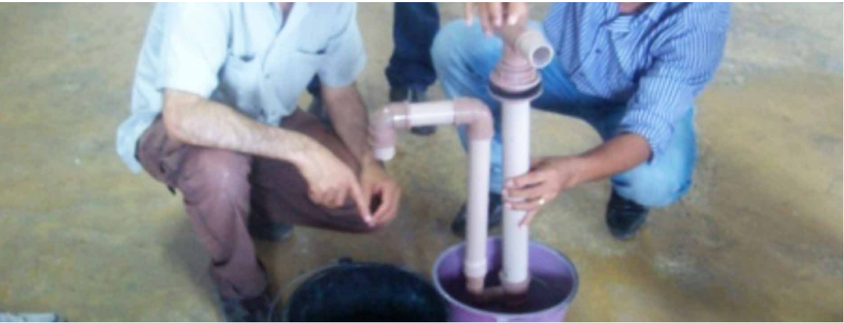
Figura 20 - Bomba de embolo de PVC funcionando.
