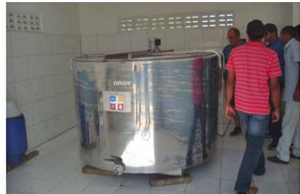
Figura 37 - Tanque de resfriamento - COOPAZ.
