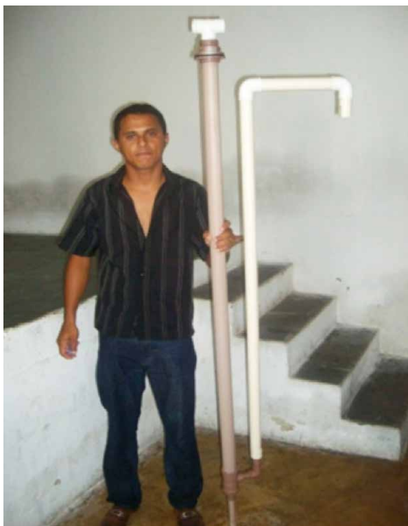
Figura 19 - Bomba de pistão de PVC pré-montada.
