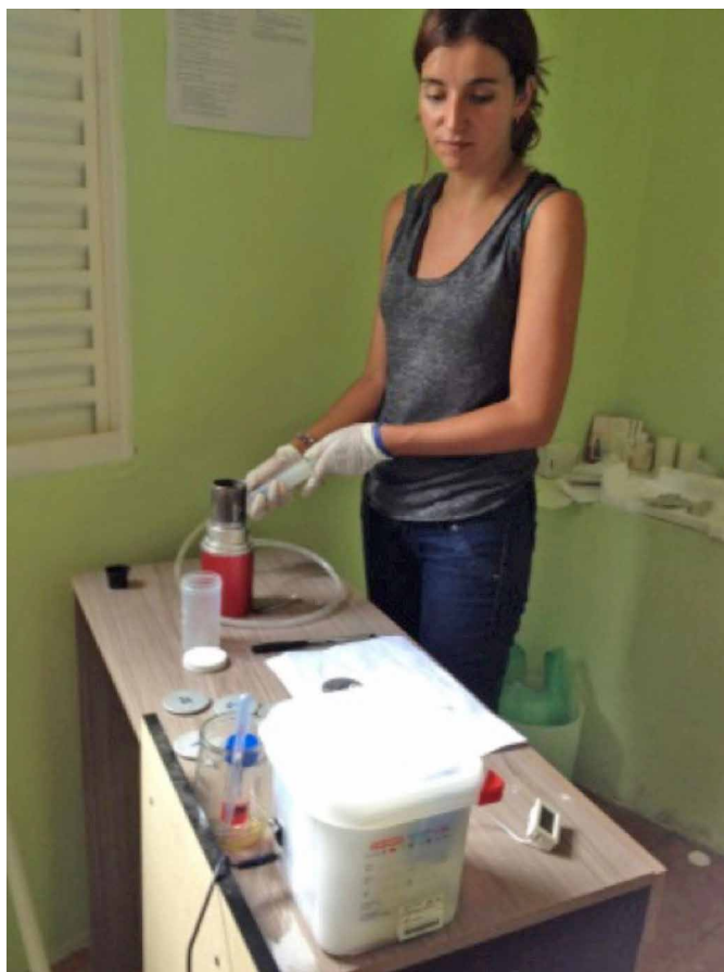
Figura 32 - Medição de coliformes fecais em mini laboratório.
