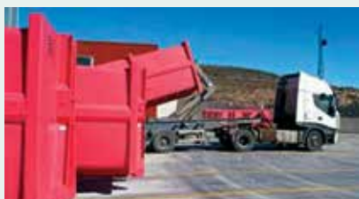
Carga dos resíduos compactados em caminhão de maior capacidade.
