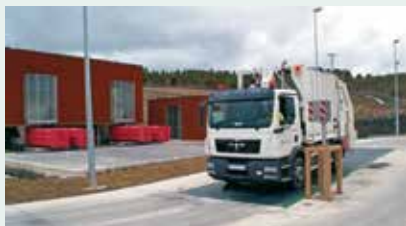
Pesagem de caminhão na entrada da plataforma de transferência. Consórcio de Resíduos de Navarra
