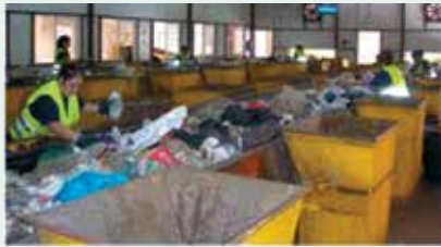
Revisão de contêineres com diferentes tipos de resíduos que podem ou não compactar-se segundo sua tipologia
