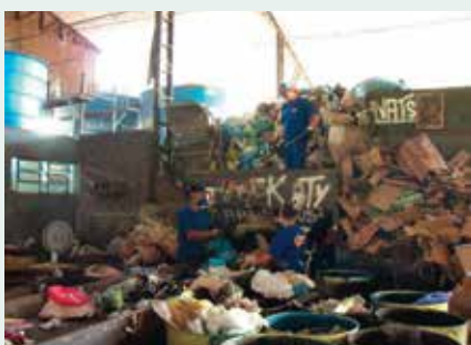
Figura 25. Alimentação de esteira de triagem.
