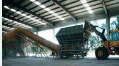
Tais resíduos carregam-se no funil que alimenta uma esteira transportadora
