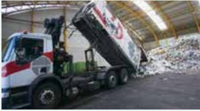
Descarga do caminhão de transporte com os resíduos misturados
