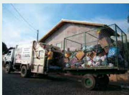
Figura 4. Reboque para coleta seletiva acoplado ao caminhão da coleta regular no município de Tibagi, PR.
