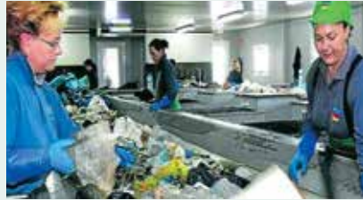
Seleção manual de diferentes tipologias de resíduos que se complementa com outras mecanizadas como imãs para a separação de metais férricos...
