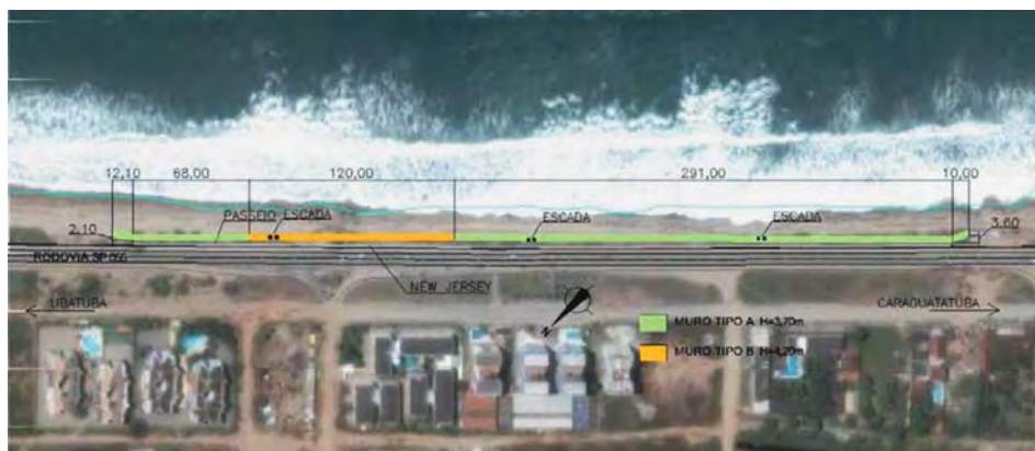
Figura 4 – Forma em planta do muro de pedra argamassada localizado na zona de erosão na praia de Massaguaçu
