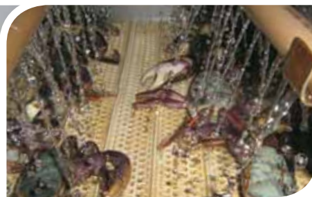
Figura 24. Sangria dos caranguejos em esteira com água a temperatura inferior a 5°C por cerca de 10 minutos
