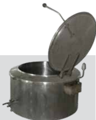
Figura 13. Panelão industrial para cozimento dos caranguejos
