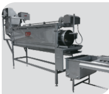
Figura 59. Máquina de extração de carne de caranguejo ( www.cmpequipment.com )
