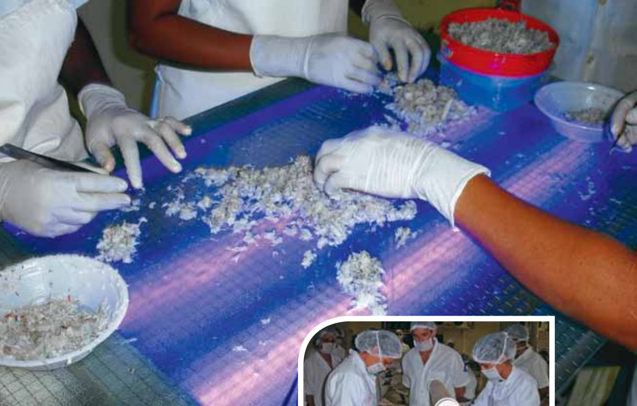
Figura 36. Emprego de luz ultravioleta para a retirada de cartilagens e outras impurezas da carne de Caranguejo
