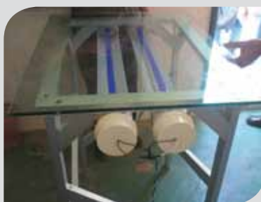
Figura 15. Mesa de luz Ultra Violeta (U.V.) para visualização de cartilagens na carne do caranguejo-uçá
