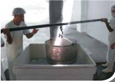
Figura 29. Resfriamento dos caranguejos em água com gelo durante 10 a 15 minutos
