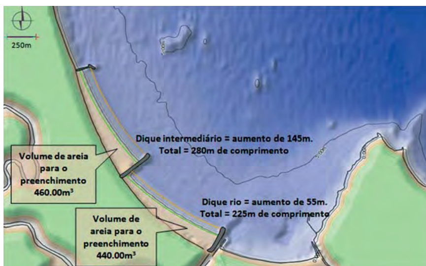
Figura 12 – Alternativa 2: para obtenção de duas praias em equilíbrio estático e a futura profundidade de fechamento ( h^*=3,1\text{m} para o dique intermediário e h^*=2,5\text{m} para o dique na desembocadura, linha laranja)
